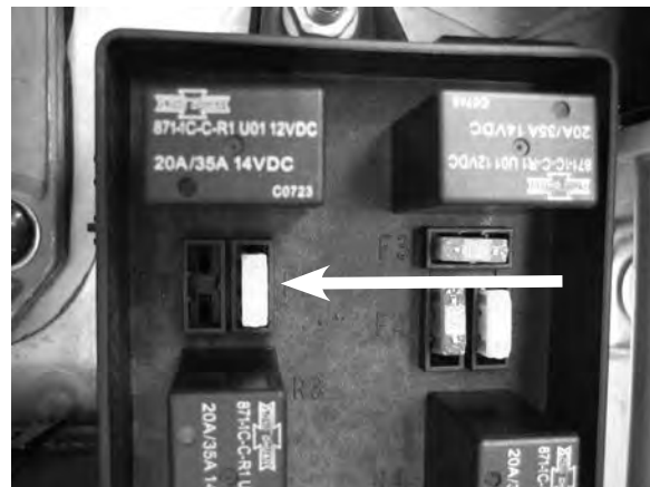
12: Instale un fusible de 20 amperios en la posición "F2".
