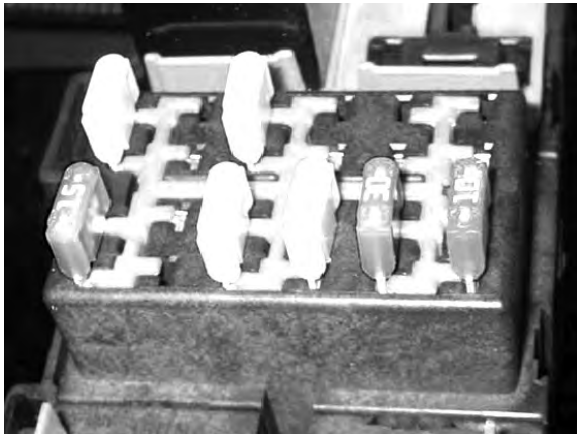
5: Quite los fusibles de la tarjeta (PCB) "DDEC". Tome nota de sus lugares correspondientes.
