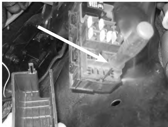
4: Quite la cubierta posterior del "DDEC6 PDB" utilizando un pico de hielo como se muestra en el dibujo.
