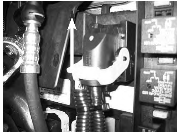
10: Reinstale el conector "X57" al conector "SAM" y levante el mango amarillo para asegurarlos.
