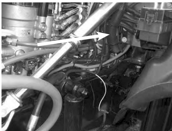
4: Guié el cable de energía de 12VDC hacia el conector del chasis marcado como "SAM". (Utilice abrazaderas de plástico para juntar los cables cuando sea necesario)
