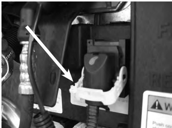
5: Localice el conector marcado como "X57" y quite el mango amarillo para soltar el conector.
