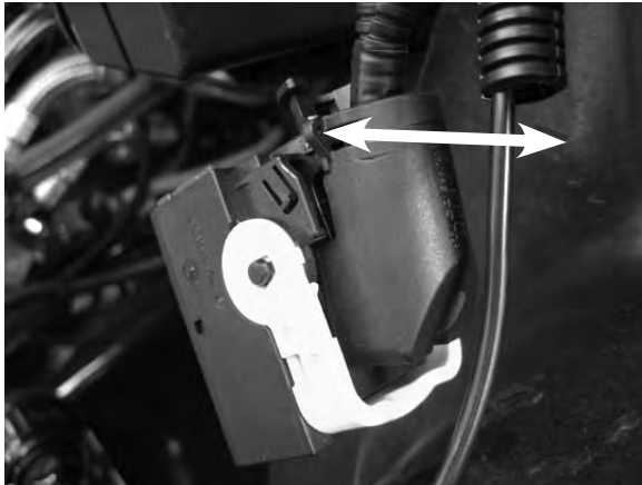
9: Reinstale la cubierta del conector "X57", empuje los candados hasta que cierren.
