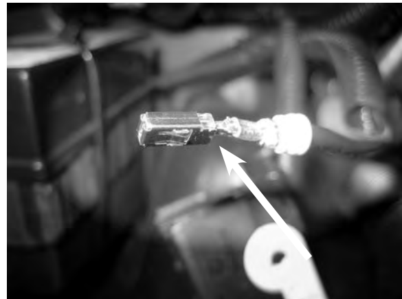
8: Corte y selle la terminal del chasis marcado como "SAM" con cinta aislante.
