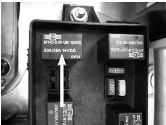
11: Instale un revelador de 20/25 amperios en la posición "R1".
